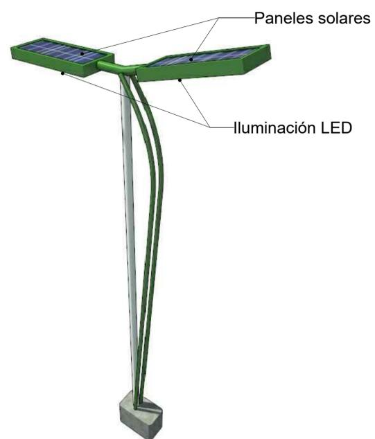
Prototipo de luminaria solar para los puentes peatonales, la terraza del edificio multusos y algunos senderos
