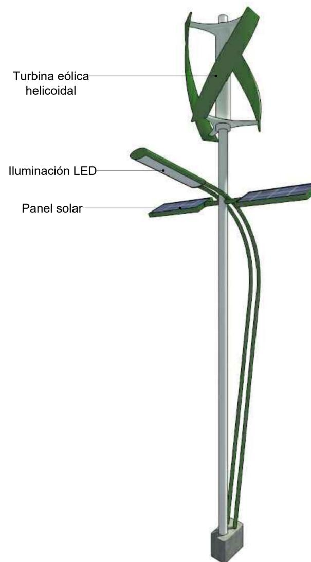
Prototipo de luminaria con alimentación solar y eólica para los senderos superiores y calles
